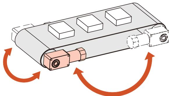
中空轴减速电动机还简化了连结零件，从而可减少零件成本和组装工时。
