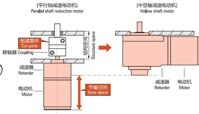
图为输出功率200W，减速比5的平行轴减速电动机与直交轴减速电动机的比较。
